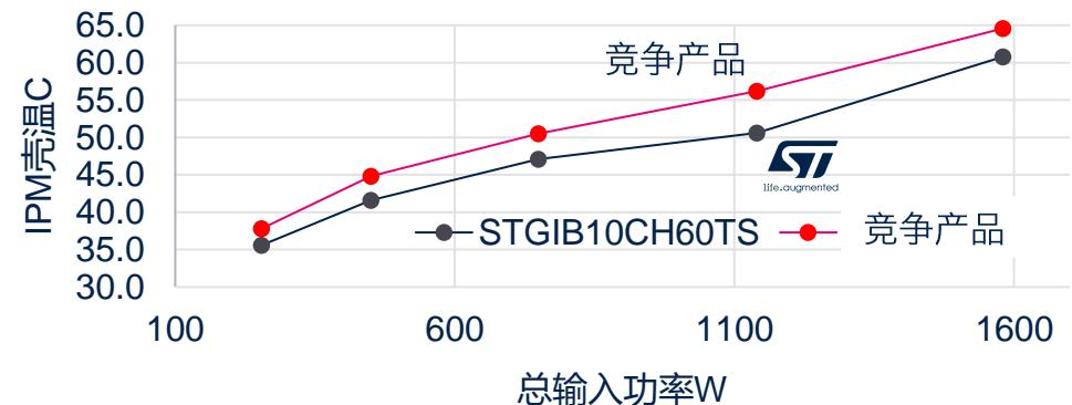
在IPM的IN/OUT上测量效率，使用ST MC SDK v4.3 的FOC驱动BLDC电机，在空调上实际应用上测试所得。
