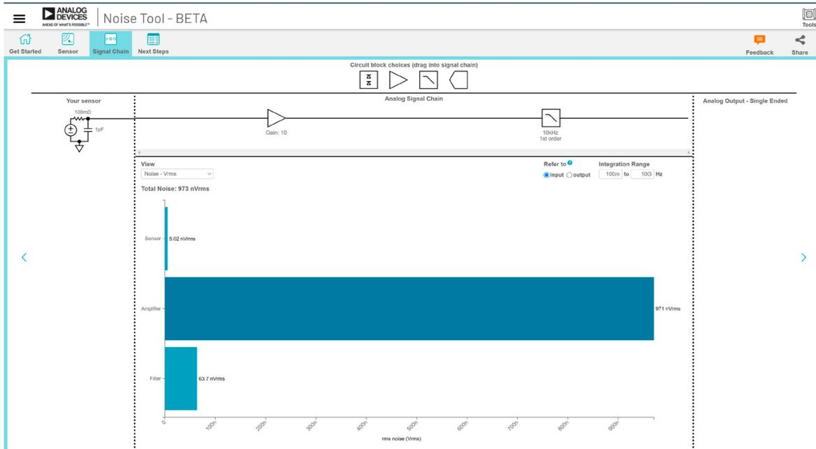
图 6. ADI Precision Studio 中的信号链噪声工具
