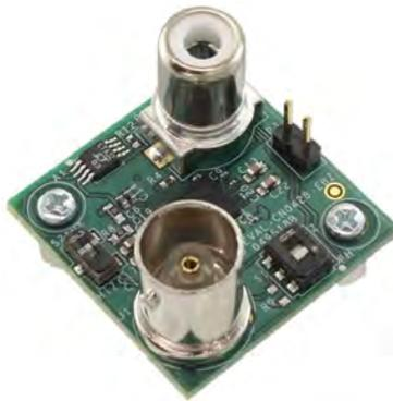
图5. 具有BNC和RCA连接器的ADuCM355 pH值测量PCB。
