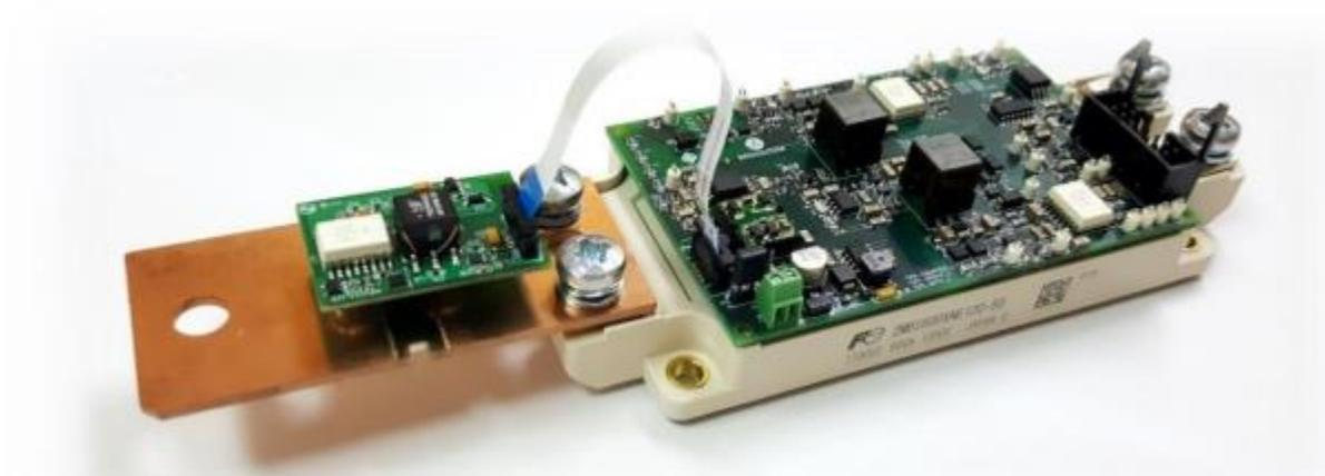
EB1200-339J 最初设计为与富士电机 (Fuji Electric) 的 *EconoDUAL™* IGBT 模块 2MBI600XNE120-50 一起使用。通过对 DESAT 保护和栅极电阻进行适当的调整, EB1200-339J 可以通过相同的引脚分配支持额定功率从 1200V/225A 至 1200V/1000A 的其它 *EconoDUAL™* XT 模块。
