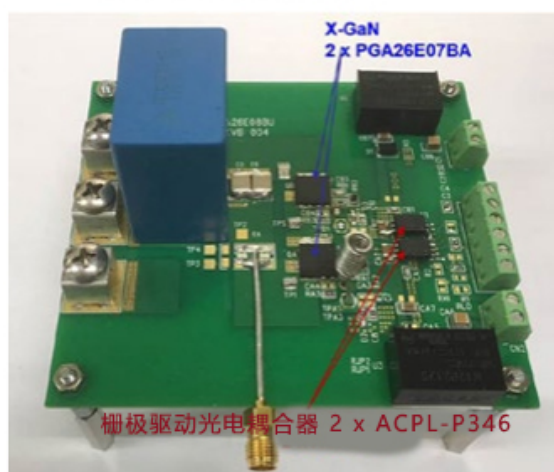
图 4：采用松下的 GaN 和 ACPL-P346 的半桥评估板
