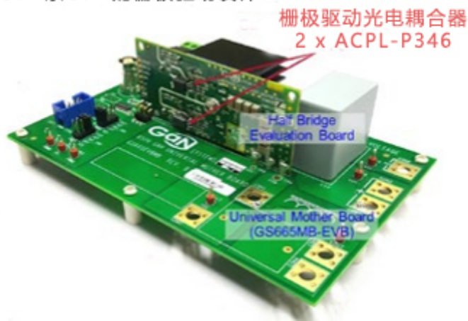
图 6：采用 GaN Systems 的 GaN 和 ACPL-P346 的半桥评估板
