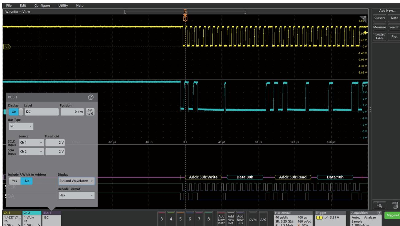
有一种更好的方式。上面的实例显示了用于自动解码和触发的 I<sup>2</sup>C 串行总线设置。它显示了配置菜单和解码画面，包括模拟输入信号和数字波形。解码后的总线业务在总线写入十六进制地址 50 时触发。
