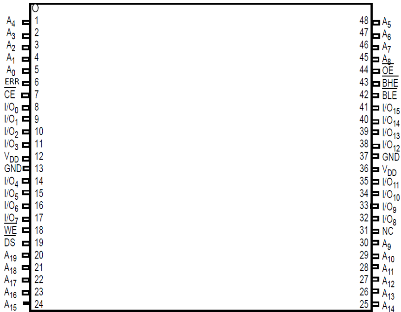
图 5. 48 pin TSOP I (12 x 18.4 x 1 mm) 引脚分布, 引脚 6 为 ERR 输出 (顶视图)
