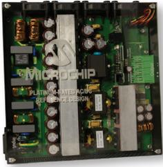
该参考设计用于演示dsPIC DSC在开关电源（SMPS）中的灵活性，具有94.1%的峰值效率，达到了ENERGY STAR® CSCI白金级。它具有一个双相交错式功率因数校正升压转换器，并跟随一个带同步整流功能的双相交错式双开关正激转换器。
