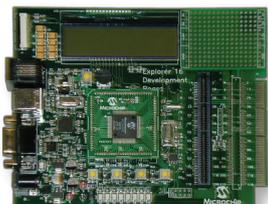
Explorer 16是一款高效的低成本开发板，用于评估Microchip 16位PIC24F和PIC24H MCU、dsPIC33 DSC以及32位PIC32MX系列的特性和性能。它可以与MPLAB® ICD 3在线调试器或MPLAB REAL ICET™在线仿真器接口，加快应用电路的评估和原型设计。该开发板具
