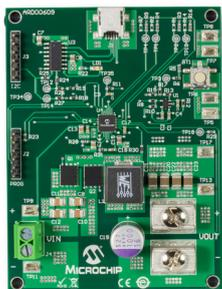
该演示板用于演示MCP19111器件如何在宽输入电压和负载范围内作为支持PMBus的POL转换器工作。固件已预先装入MCP19111，所以无需进行软件开发。其中包含了一个USB转PMBus桥接器，支持使用PICkit™ 3在线调试器/编程器与PC直接进行通信。几乎所有工作和控制系统参数都可通过PMBus进行编程和读取。您可以从Microchip网站下载易于使用的全功能GUI，也可以使用自己的针对
