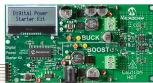
该工具包使用dsPIC33EP64GS502 DSC来实现降压转换器和升压转换器。每个转换器都可以驱动其板载MOSFET控制的阻性负载或外部负载。该开发板具有用于显示电压、电流、温度和故障状况的LCD显示屏，以及集成的编程器/调试器，它们全都通过附含的9V电源供电。
