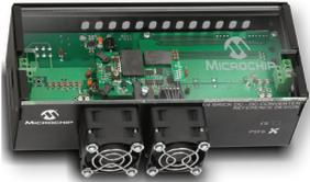
该参考设计提供了一种简便的方法来评估高密度四分之一砖直流/直流转换器中的SMPS DSC的性能和特性。
