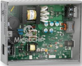
在该参考设计中，使用单个dsPIC33F“GS”数字电源DSC来提供电源转换的全数字控制和系统管理功能。它可在较宽的输入电压范围（直流350-420V）工作（标称输入为400V，提供12V直流输出），同时维持初级侧和次级侧之间的高压隔离。
