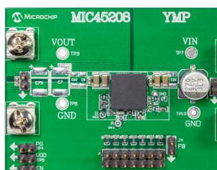
MIC45208是一个同步降压稳压器模块，采用了独特的自适应开启时间控制架构。该模块在单个封装中包含了直流/直流控制器、功率MOSFET、自举二极管、自举电容和电感，简化了设计和布板的过程。该模块可接受4.5V至26V输入，产生最高10A的0.8V至5V输出，并且开关频率可调。
