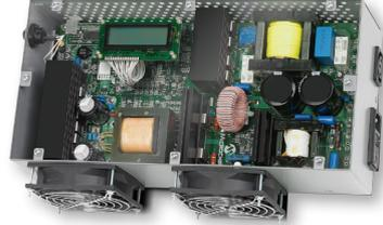
该参考设计使用单个dsPIC33F“GS”数字电源DSC实现，用于演示如何对UPS应用采用数字电源技术，通过更加纯净的正弦波输出来降低噪音与电气噪声。此外，它还说明了这些技术如何支持这
