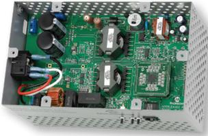
该参考设计提供了一种简便的方法来评估用于IPFC应用的SMPS dsPIC DSC的强大功能和特性。它具有通用输入电压范围，产生单个最高350W的高电压直流输出，并且输入电流的总谐波失真（THD）很低。
