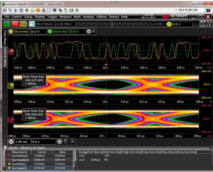
图 13. 查看具有串扰的受扰信号的眼宽和眼高，并与没有串扰的信号进行比较。
