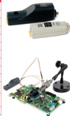
探头带来的噪声是在衰减器前面耦合进来的，在某些不正确的使用方法下，探头可能会带来额外的噪声，一个典型的例子就是使用长地线。为了方便测试，示波器的无源探头通常会使用 15cm 左右的鳄鱼夹形式的长地线，这对于电源纹波的测试是不适用的，特别是板上存在开关电源的场合。由于开关电源的切换会在空间产生大量的电磁辐射，而示波器探头的长地线又恰恰相当于一个天线，所以会从空间把大的电磁干扰引入测量电路。一个简单的验证方法就是把地线和探头前端接在一起，靠近被测电路（不直接接触）就可能在示波器上看到比较大的开关噪声。因此测量过程中应该使用尽可能短的地线。
