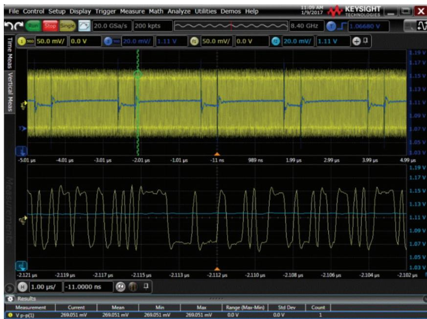
上图：左图，FPGA 直流电源和 MXR/EXR 系列示波器捕获的串行数据。数据线（黄线）；电源（蓝线）。
