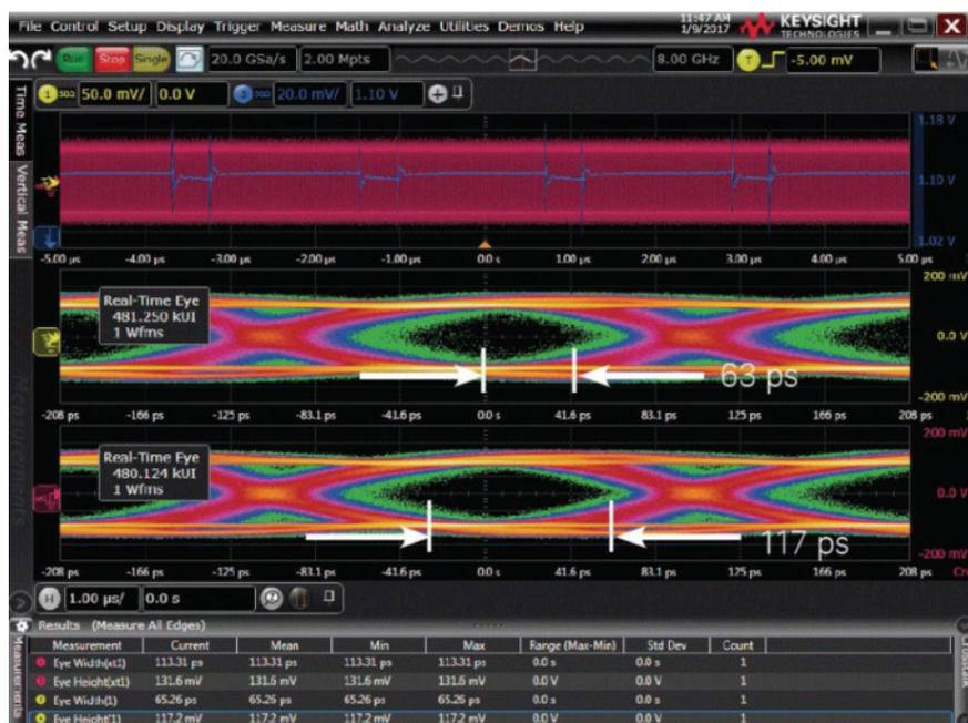
上图：从上之下，串行数据和“不干净”的 1.1V 直流电源信号，实测的由于电源串扰所影响的串行数据眼图（眼宽 63ps），D9010POWA 软件推测的去除 1.1V “不干净” 直流电源信号后的串行数据眼图（眼宽 117ps）。
