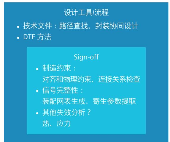
图 2. 封装装配设计套件的组件。
