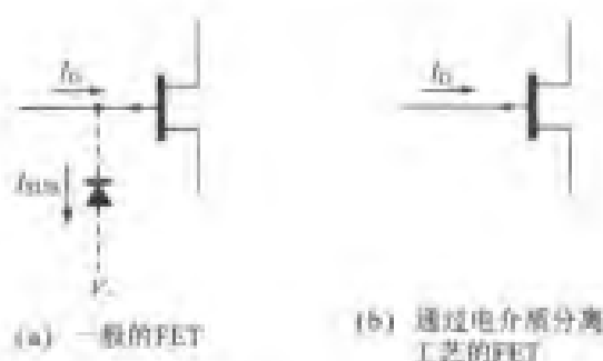
图 4.2 FET 的构成与电介质分离技术
