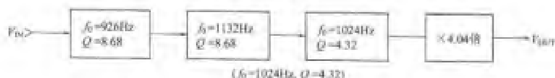
图 9.25 带通滤波器的通频带特性的的 f_0 和 Q 值
