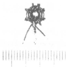
照片 6.19 实验中使用的环形铁心[T-25-6, 8 匝双线绕法, 阿密顿公司]
