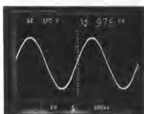
照片10.9 6 位 DAC 输出波形
