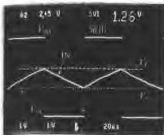
照片 3.2 74HC14 振荡电路的振荡波形
