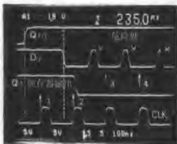
照片 10.2 数字波形发生电路的定时
