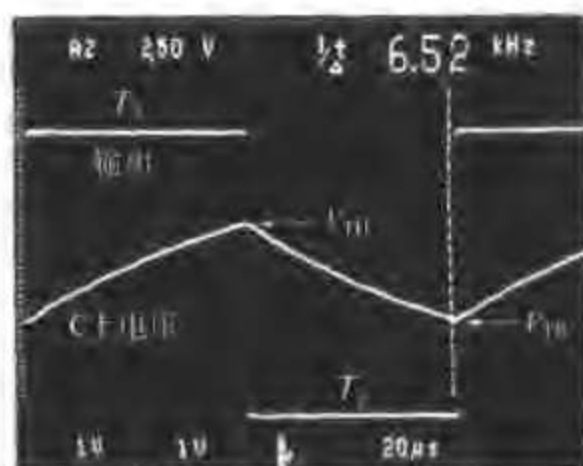
照片 3.13 R_A = 1\text{k}\Omega , R_B = 10\text{k}\Omega , C = 0.01\mu\text{F} 时振荡波形 (原理上说, 555 振荡电路的波形占空比不能为 50%。要使占空比接近 50%, 需要 R_B 与 (R_A + R_B) 电阻值之比为 1:1, 这就是 R_B \gg R_A 。这里示出这种情况的实验波形实例)
