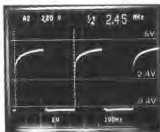
照片 2.4 2.4576MHz 时 TCO707F 输出波形
