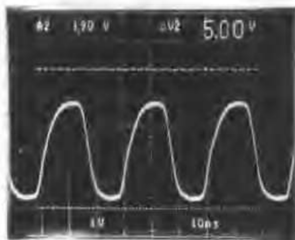
照片 2.16 用铁氧体磁环使波形变圆滑的实例
