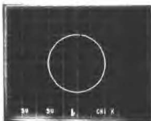
照片 4.11 正弦输出与余弦输出形成的利萨茹图形
