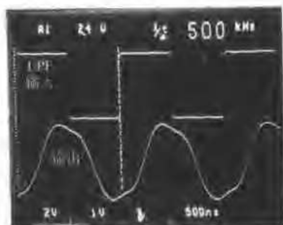
(a) 输入频率为 500\text{kHz} 时波形
