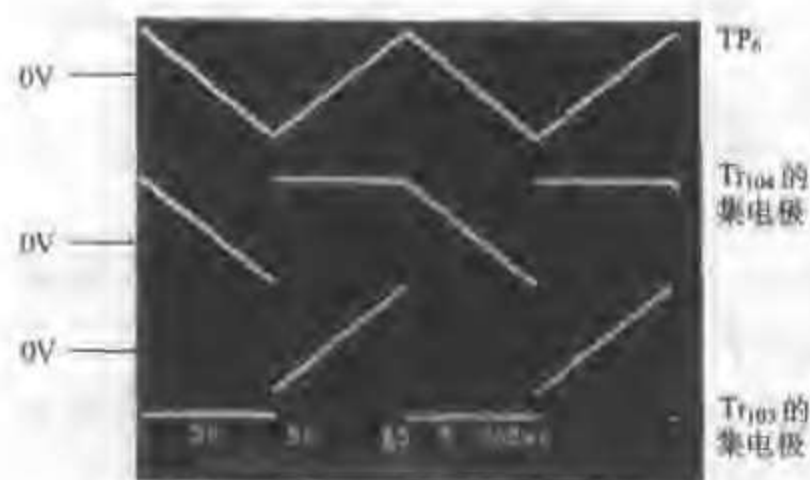
照片7.7 正负斜波合成的波形
