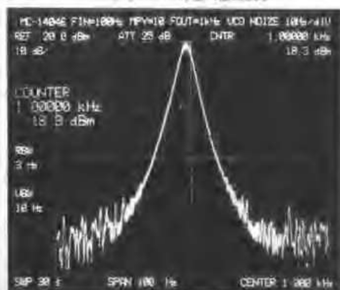
(d) f_0=1\text{kHz} 时 VCO 的噪声
