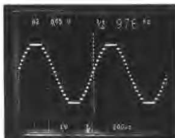
照片10.7 4 位 DAC 输出波形
