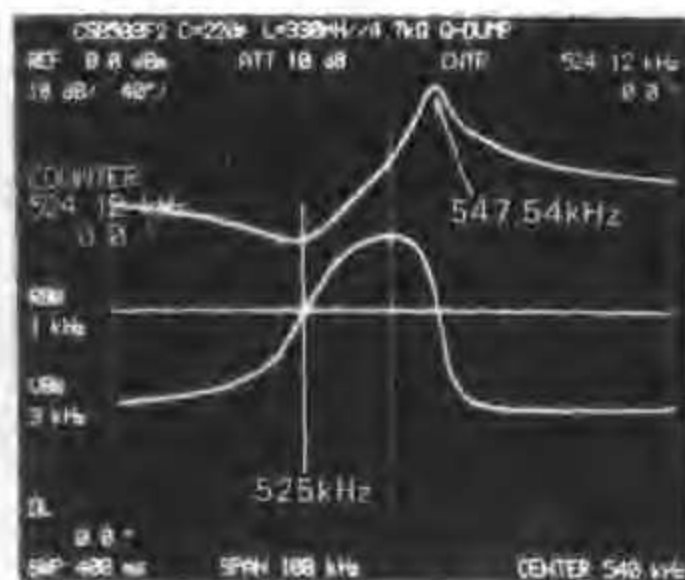
照片 8.9 陶瓷振子串联电容 C_s 与串联电感 L_s 时阻抗特性
