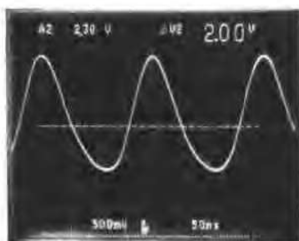
照片 8.15 VCXO 电路中晶体管发射极的输出波形
