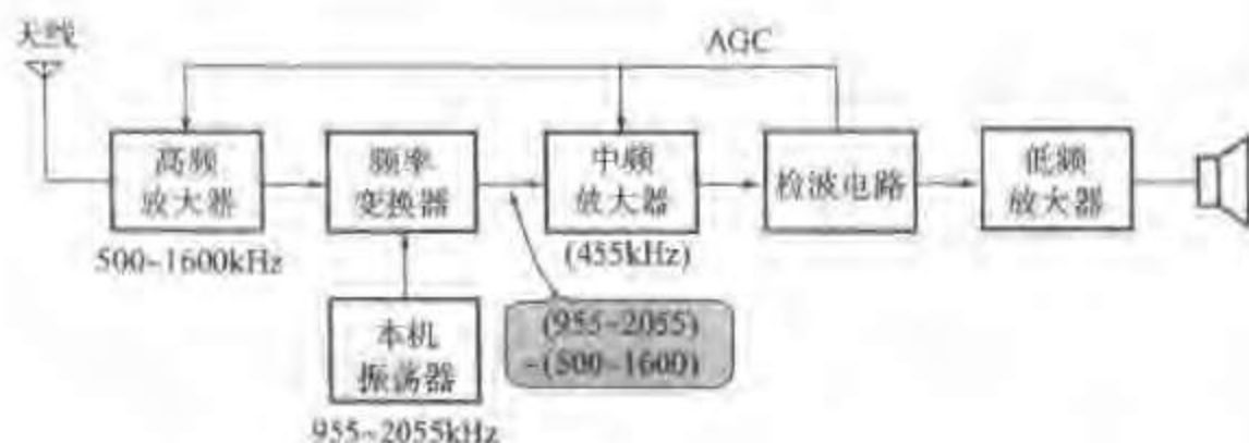
图 1.3 无线接收机等中使用的本振实例
