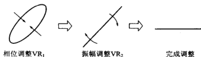
图 3.42 BEF 的输入输出李沙育波形(输入:X,输出:Y)
