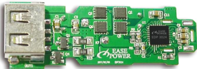
支持A、C两个输出口；A口支持BC1.2/DCP/QC3.0，C口支持BC1.2/DCP/QC3.0/PD2.0，两个口同时插入时输出将为5V；支持36W、45W、65W和100W输出功率；支持5V、9V、12V、15V、20V完整PD2.0协议；支持苹果、HP、DELL、华为、小米、任天堂等笔记本、平板、手机和游戏机，兼容性优异；对手机充电不反灌；支持12V/24V输入，芯片耐压40V；支持线补；支持输出功率根据不同协议智能调节；单芯片方案无需单片机和协议芯片，生产简单，可靠性高，性价比高。
